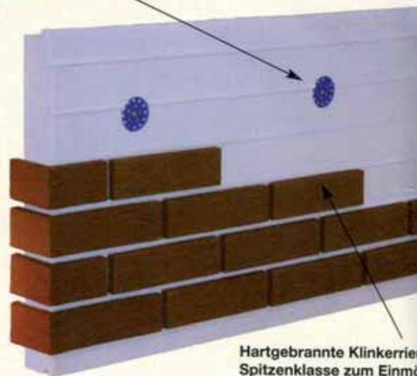
Hartgebrannte Klinkerriemchen Spitzklasse zum Einmörteln in das ausgefräste Riemchen
